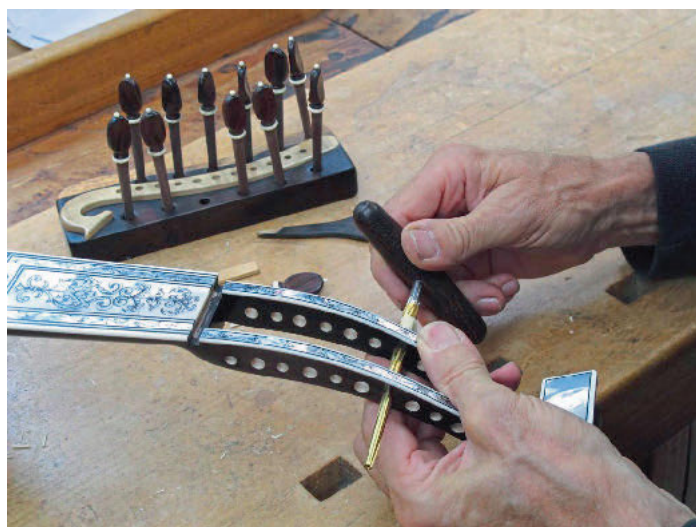
/ Die hölzernen Stimmwirbel werden mit einer konischen Reibahle präzise in den reichlich mit Perlmutt und Gravuren verzierten Wirbelkasten eingepasst.
