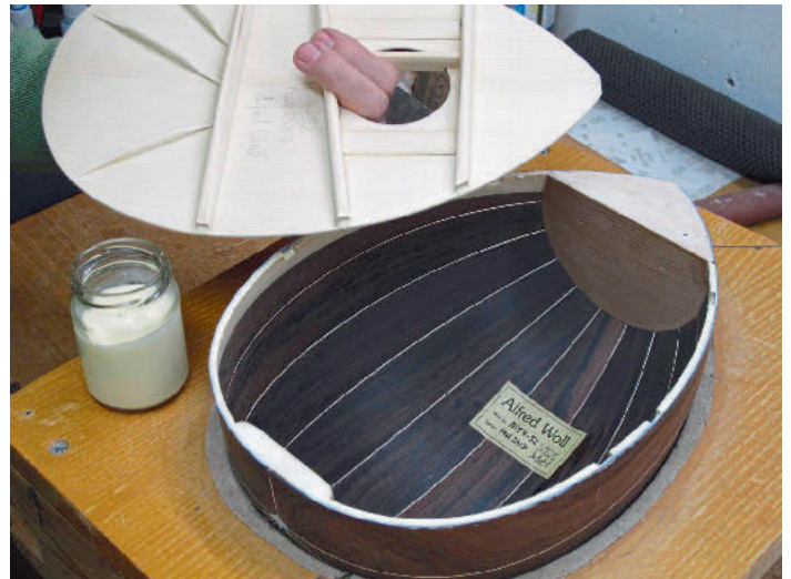
/ Versehen mit einem Einkleber zu Hersteller, Modell und Baujahr, ist die fertige Muschel bereit zum Aufkleimen der beleisteten Decke aus feinjähriger Fichte.
