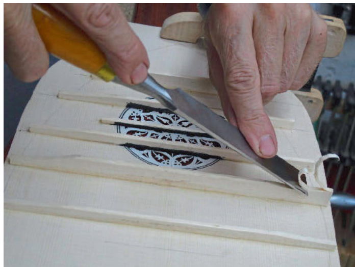
/ Statische Aussteifung: In reiner Handarbeit und mit jahrelanger Erfahrung bearbeitet Alfred Woll die Balken des historischen Nachbaus einer Barockmandoline.
